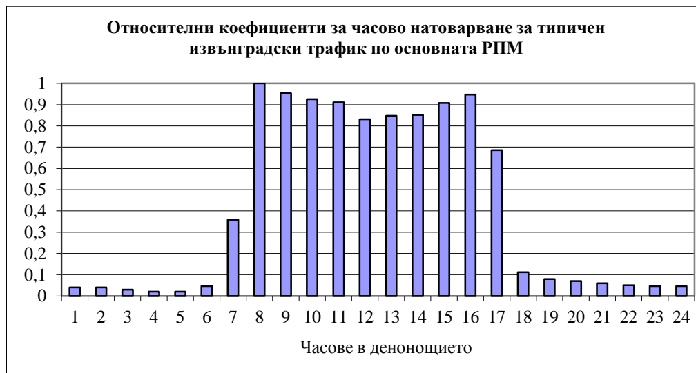
Фиг. 45 Относителни коефициенти за часово натоварване за типичен извънградски трафик по основната РПМ
