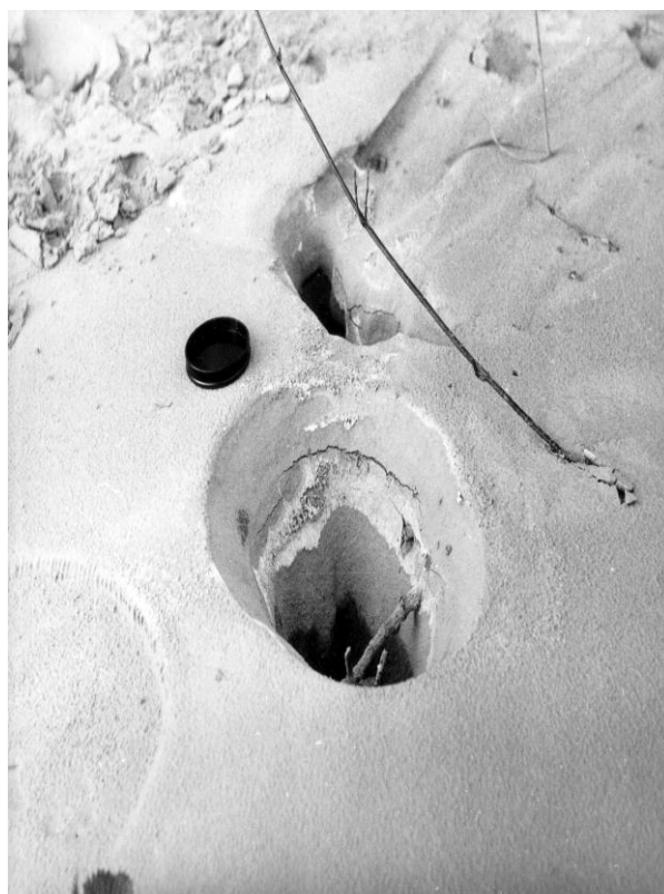
Фиг. 2.28. Деформации на терена причинени от втечняване на водонаситени пясъци в района на село Вардим (сн. акад. Ил. Бручев)
