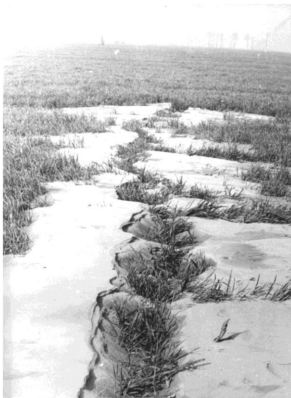
Фиг. 2.27. Деформации на терена причинени от втечняване на водонаситени пясъци в терасата на река Янтра при с. Новград (сн. акад. Ил. Бручев)
