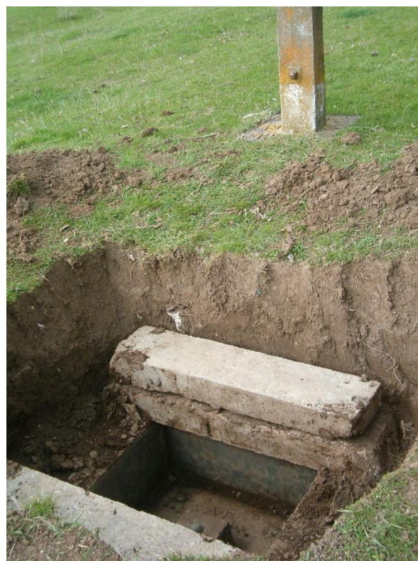
Снимки на векови нивелачен репер (ВНР) 259 (II клас, код 12) и показалец (код 7) към него
