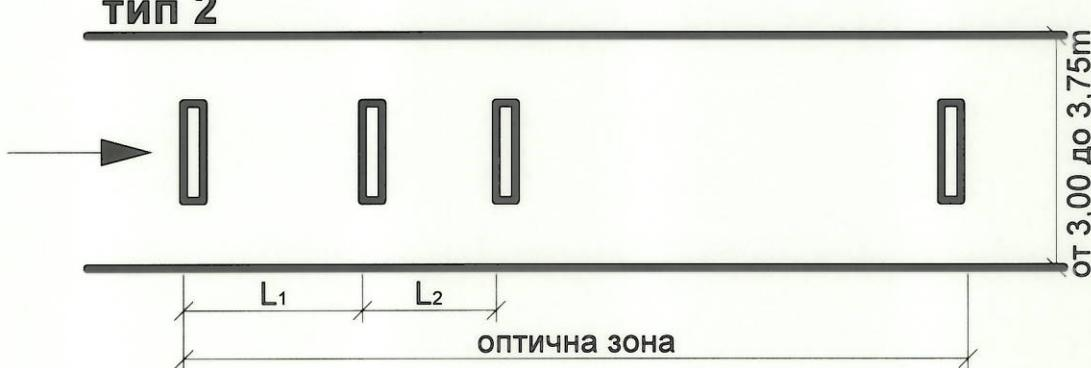
Фиг. III.16. Напречна оптична маркировка М19
