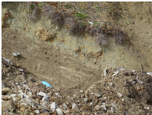
Ляв свлачищен борд с харниши /бразди на триене по направление на движението/
