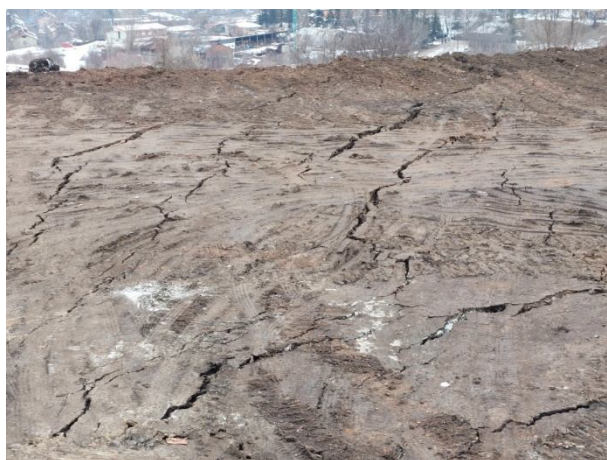
Оформена свлачищна тераса под главния свлачищен откос със значими деформации
