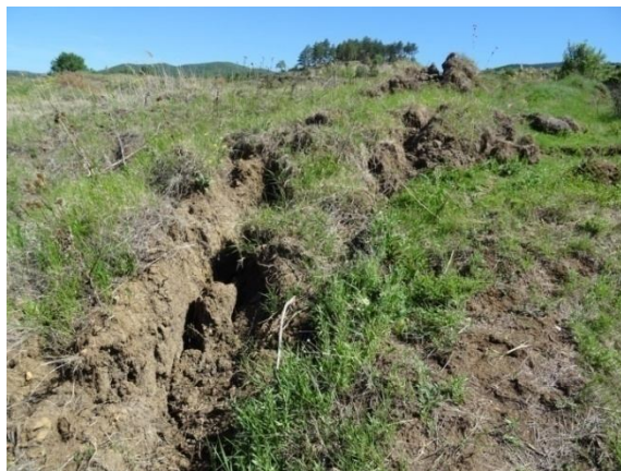
Теренни деформации в средната част на участъка при левия свлачищен борд
