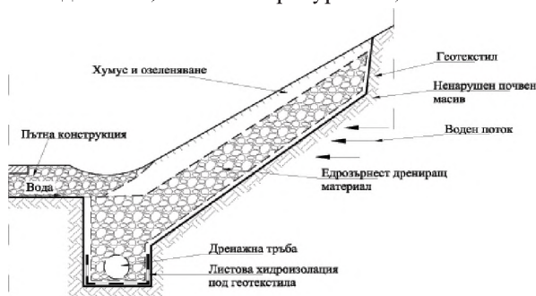
Фигура 128. Площен дренаж, свързан с надлъжното отводняване
