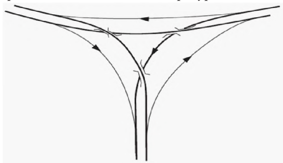
Фигура 79. Свободно планиран пътен възел тип „Триъгълник“
