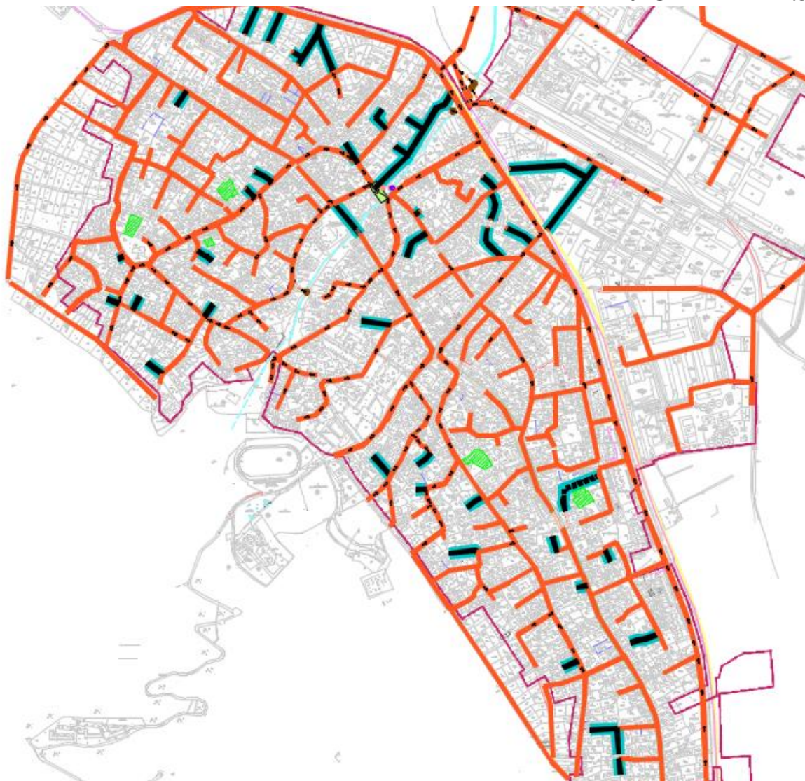
Фигура 4-2 Вариант за реконструкция и доизграждане на канализационната мрежа на Агломерация „Горна Оряховица- Лясковец“ – гр. Лясковец
