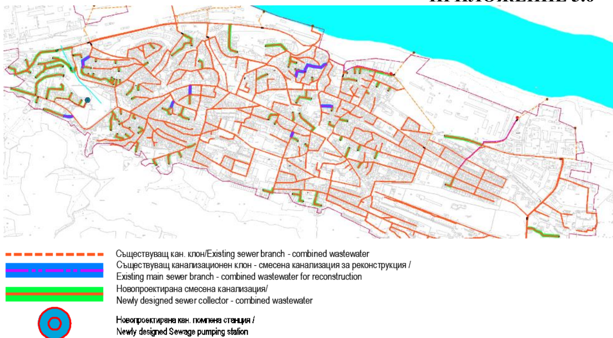
Фигура 4-1 Вариант за реконструкция на канализационната мрежа на Агломерация „Свищов“ – гр. Свищов
